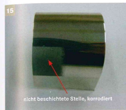
Abb. 15: Beschichtetes und danach gebogenes Aluminiumblech (Biegeradius 15 mm)
